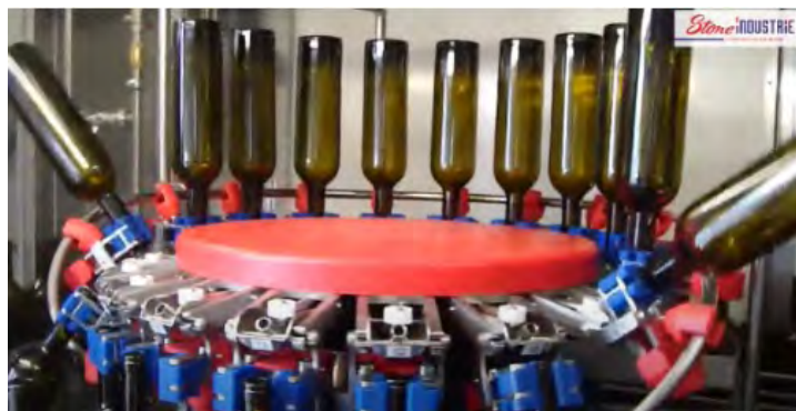
Exemple d'insuffleuse Stone industrie , cadence de 2 500 à 20 000 bouteilles/h
